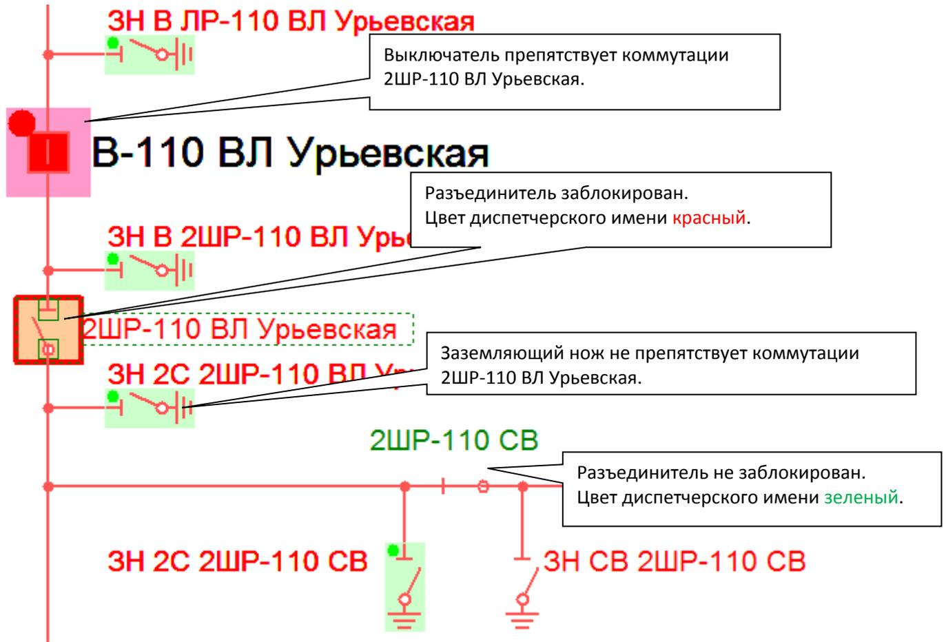
Рис. 4.2. Пример визуализации блокировки разъединителя – разъединитель заблокирован.
