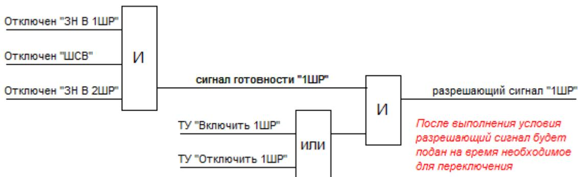
Контроллер блокировки получает в виде телесигналов флаги-телеуправлений от контроллера телемеханики. Когда система ОИК подает телеуправление приводом и выполняется «условие коммутации», контроллер замыкает «реле блокировки», а система визуализации получает «разрешающий сигнал».
